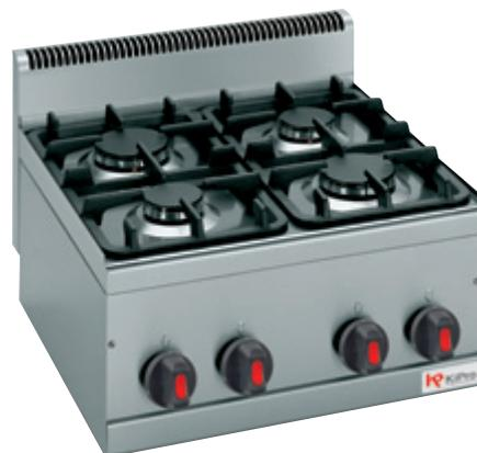
Piano stampato a tenuta stagna in acciaio inox AISI 304. Griglie supporto pentole in ghisa smaltata a fuoco. Bruciatori stagni, in lega di alluminio e ottone da 3 kW e 3,6 kW con spartifiamma in ghisa smaltata a fuoco. Sistema di sicurezza a termocoppia. Angoli arrotondati, giunti coprifuga, superfici completamente lisce e facili da pulire, camino rialzato con funzione paraspruzzi, piedini in acciaio inox regolabili fino a 50 mm.
