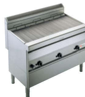
Rivestimento esterno in acciaio inox, piano lavoro di spessore 12/10 con spigoli arrotondati. Bruciatori a fiamma stabilizzata con corpo in ghisa e spartifiamma del tipo a doppia corona. Regolazione di fiamma tramite rubinetti valvolati con sistema di sicurezza a termocoppia e fiamma pilota. Bacinelle di raccolta liquidi smaltate e amovibili per facilitare le operazioni di pulizia.
