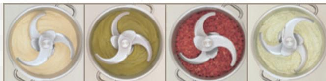
**R 23** > Cutter da pavimento con corpo macchina totalmente in inox. Vasca inox smontabile e ribaltabile da 23 lt con coperchio in policarbonato trasparente a tenuta liquidi e gruppo di coltelli inox smontabili a 3 lame lisce. Velocità 1500 e 3000 e comando impulsi.
