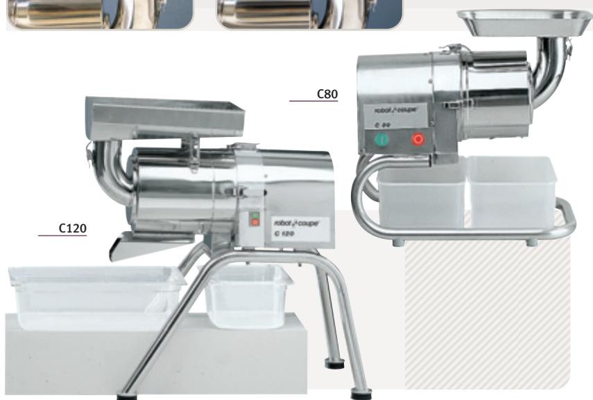
**C80** > Centrifuga estrattrice di succo/polpa versione da banco, costruita in inox e fusioni di alluminio, dotata di cestello filtrante da Ø 1 mm, due raccoglitori per il prodotto e lo scarto. Velocità 1500 RPM. Produzione oraria 50 kg.
